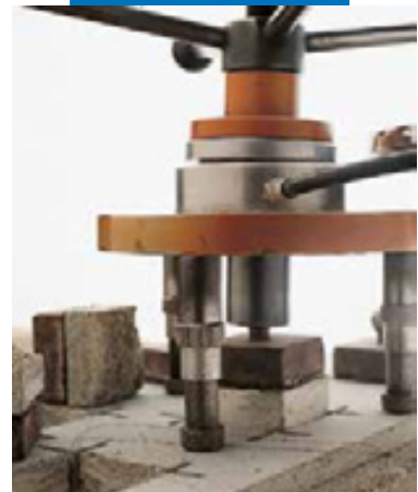
Испытание на адгезию SATTEC
