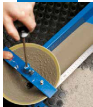
Испытание расширения в канавке согласно норме UNI 8997/89
